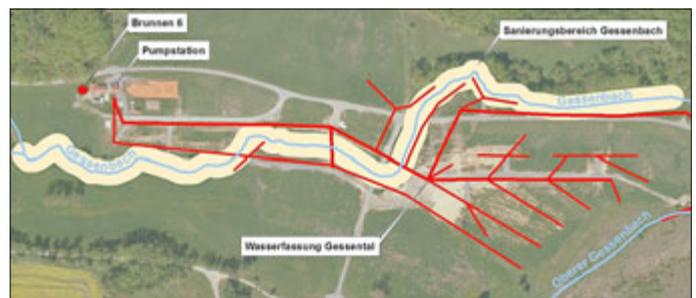
Übersichtsdarstellung für das Grundwasserfassungssystem und den zu sanierenden Bachabschnitt im Gessental auf einer Länge von ca. 750 m
